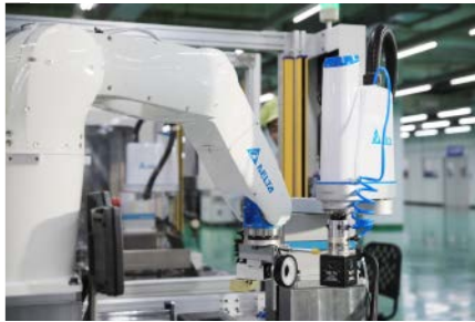
导入DRV70L垂直多关节机器人进行台达SCARA工业机器人成品功能检测，大幅缩短产品测试时间、提升检测效率，并减少人力成本
