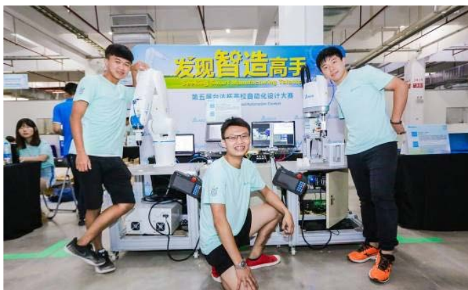
高雄科技大学“高制商整合队”利用SCARA机器人与多关节机器人，打造无人组装工作站应用方案，实现精密制造的排程优化
