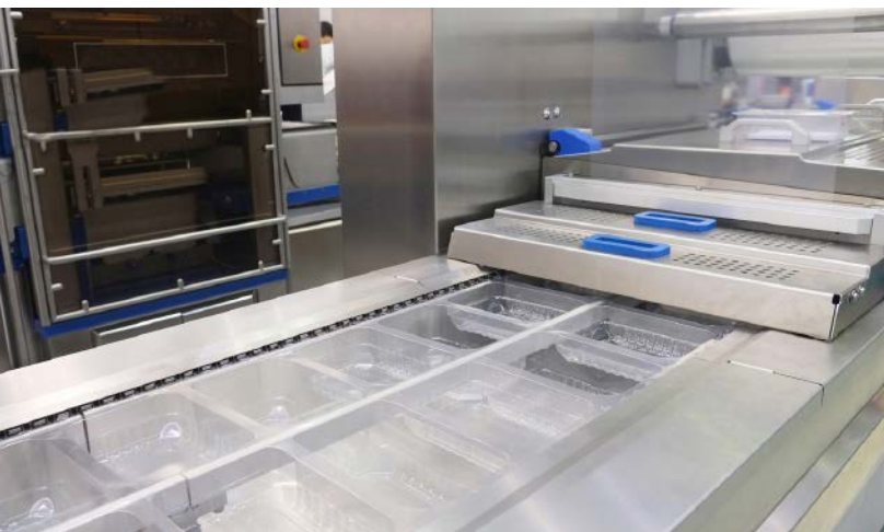
交流伺服驅動器精準定位兩軸，讓輸送帶可為湯圓成品進行擺盤與後續封裝
