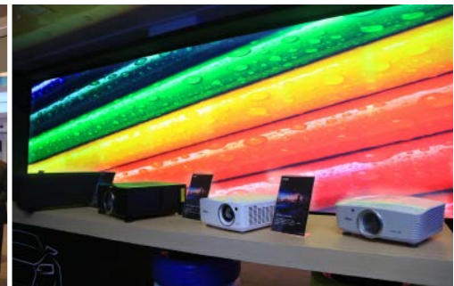
台達旗下投影品牌Vivitek展示了由8台18,000流明鐳射工程投影機DU9800Z通過融合拼接打造而成的戶外大屏汽車影院，效果驚豔
