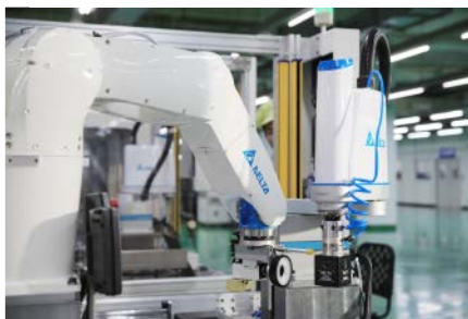
導入DRV70L垂直多關節機器人進行台達SCARA工業機器人成品功能檢測，大幅縮短產品測試時間，提升檢測效率，並減少人力成本
