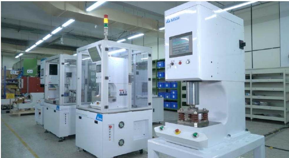
台達伺服壓床的關鍵零組件，包括程式控制器、伺服驅動器及馬達、人機介面等，皆採用台達自家研發、生產之產品，無縫整合，系統更能平穩運作
