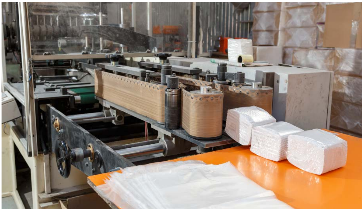
台達切膜機解決方案也可應用於擦手紙巾、單包抽取式衛生紙或衛生紙串包等多項產品包裝，提升產線設備效率
