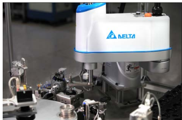
台達近日在大陸吳江的自動化產線為筆記本電腦的風扇做焊接密合度檢測
