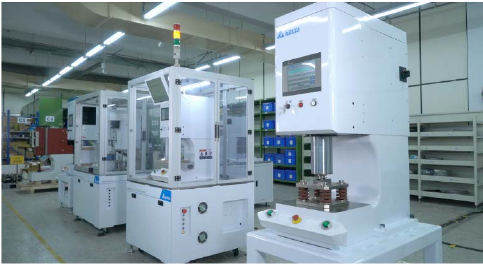
台达伺服压床的关键零组件，包括可编程器、伺服驱动器及马达、人机接口等，皆采用台达自家研发、生产之产品，无缝整合，系统更能平稳运作
