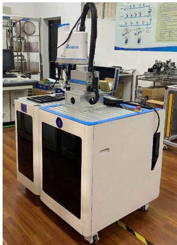
台达“人工智能实验平台”，由智能硬件-可转换智能机台（Transformable Intelligent Machine, TIM），及智能软件-自动缺陷分类、预测性维护、PC-Based控制系统等构成，重现工业应用场景
