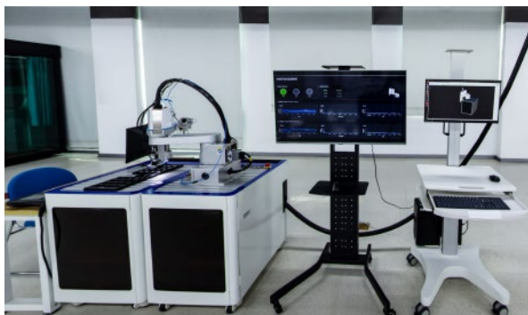
可转换智能机台及输送带，实现弹性制造
