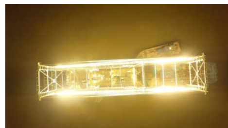
传统集鱼灯-灯光集中于船上左右侧海面反而没有船上亮
