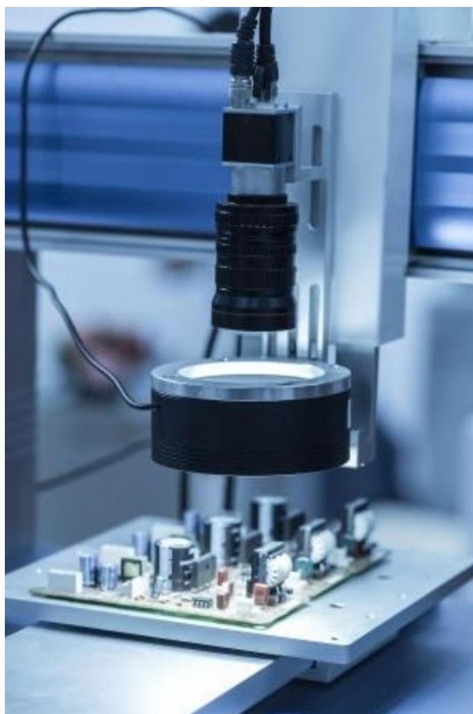
近期台達為天津一家汽車電子零部件的製造商提供 PCB 塗膠暨視覺檢測方案，大幅提升噴膠精度及檢測效率
