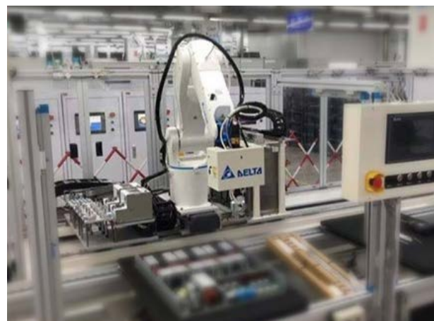
台達於大陸的PCB廠導入垂直多關節機器人DRV90L系列和機器視覺系統執行高精、高速螺絲鎖附，應用於PCB多層板流水線
