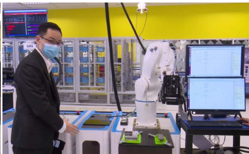
在先進製造學習歷程中，也展示了台達研究院發展的可轉換智能機台 ( Transformable Intelligent Machine )，透過智能化、模組化與標準化的方式讓機台更具彈性，因應轉型需求
