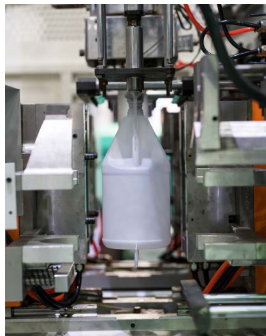
台達中空成型機方案結合全電與油電特性，具有全電高精、高速穩定，與油電大噸數的鎖模力特性，提升整體系統穩定度與塑料製品壁厚精度
