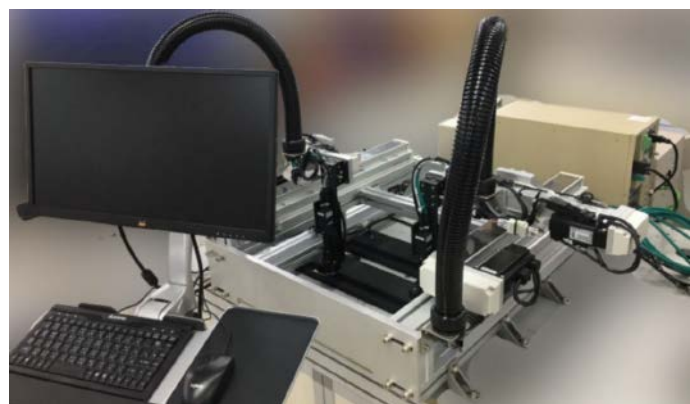
台達團隊依據多年設備經驗，運用台達EtherCAT高速運動控制系統開發出網版印刷檢查模組，可靈活裝設在不同的製程站點上，進行不同目的的在製品檢測
