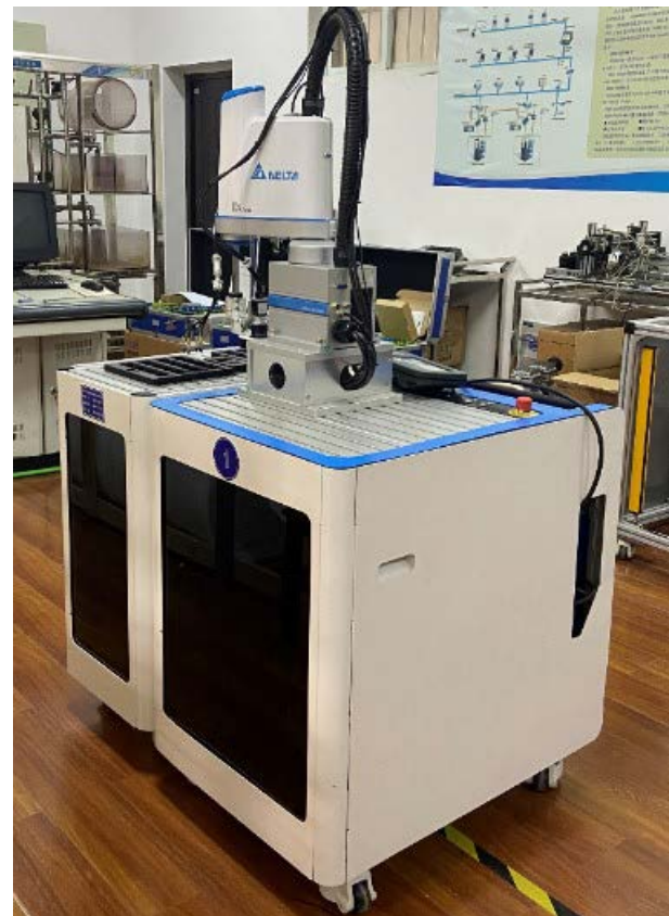
台達「人工智能實驗平台」，由智能硬體-可轉換智能機台（Transformable Intelligent Machine，TIM），及智能軟體-自動缺陷分類、預測性維護、PC-Based控制系統等構成，重現工業應用場景
