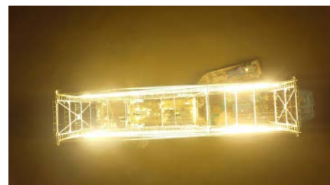
傳統集魚燈-燈光集中於船上左右側海面反而沒有船上亮
